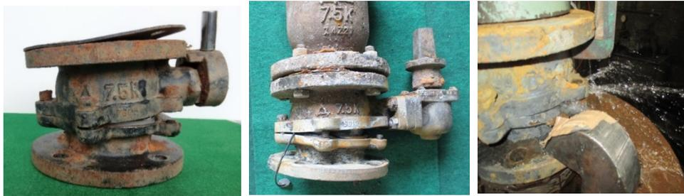
腐食進行によってボルトが破断し、弁箱が分離してしまうことが原因となっています。
